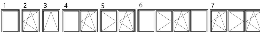
1 - Fixo | 2 - Batente de 1 folha | 3 - Basculante | 4 - Fixo + Batente | 5 - Batente de 2 folhas
